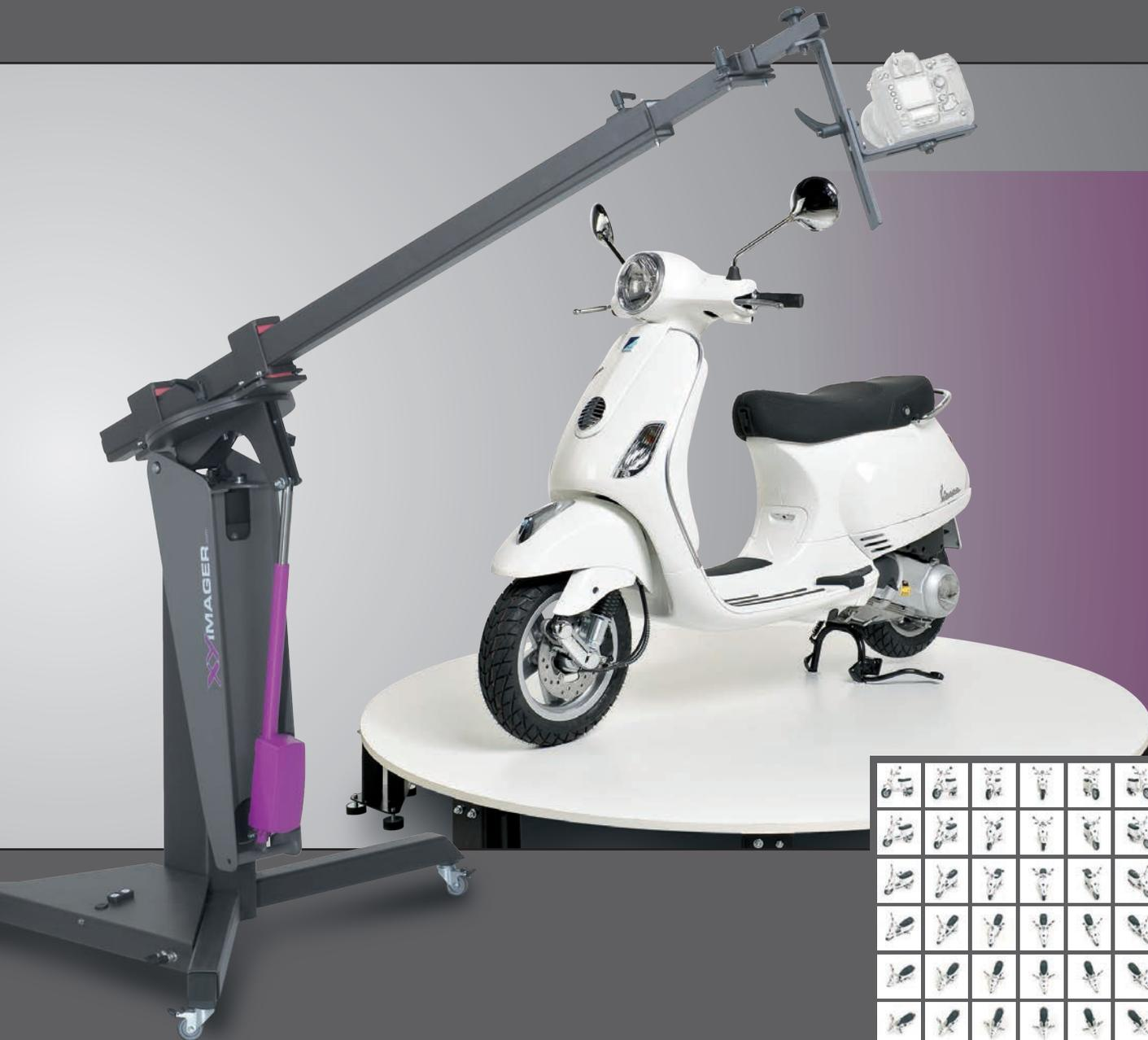
Für eine Produktdarstellung in 3D sind Aufnahmen in 360 Grad aus mehreren Achsen erforderlich, die wiederum in der X und Y Achse synchron zueinander stehen müssen. Mit dem **XY BOOM** ist die Anzahl der Achsen, sowie die Start- und die Endposition frei wählbar. Die Winkel zwischen den Achsen werden automatisch berechnet. Der letzte Einstellungswert kann bei Serienaufnahmen immer wieder abgerufen werden. Die Bewegungsgeschwindigkeit ist je nach Auszugslänge wählbar.
