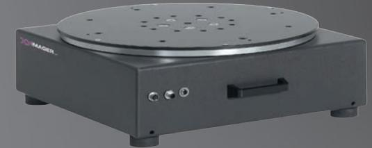
**XY SPIN 1200** ist eine Dreheinheit für zentrale Belastungen bis 1200 kg. Sie wird vorwiegend in einer festen Installation für große Drehplatten eingesetzt. Ein sehr starker Antrieb mit kugelgelagertem Drehkranz sorgt für enorme Tragkraft. Die Synchronisation in der Bewegung mit **XY SPIN TOP 50** ist auch bei diesem Gerät möglich.
