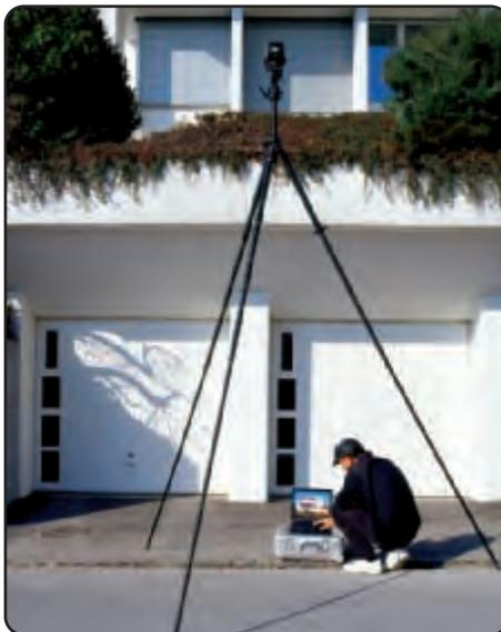
Dank COMBIROHR ist kein Hindernis unüberwindbar. Bei Bedarf und um die Stabilität zu erhöhen, können die Stativbeine mit weiteren COMBIROHR gegenseitig verstrebt werden (im Bild Dreibeinstativ ALFAE). Dies ist vor allem:
