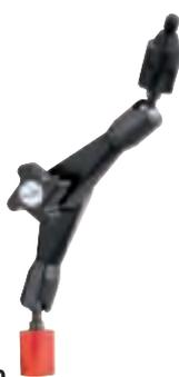
Die progressive Arretierung von unten nach oben (mit dem gleichen Drehgriff wird zuerst das unterste, dann das mittlere und zuletzt das oberste Gelenk befestigt) ermöglicht eine bisher noch nicht gekannte Präzision. Das Lösen der Gelenke erfolgt mit dem gleichen Drehgriff in umgekehrter Reihenfolge: von oben nach unten.
