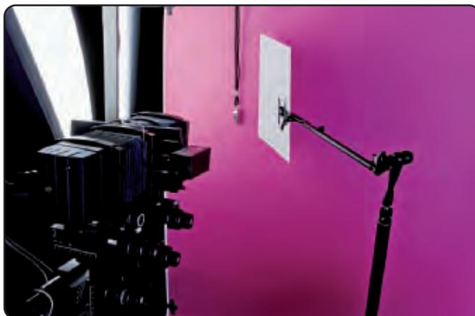
Gelenkarm CIBAE auf COMBIROHR mit Verlängerung CIBAL und verdrehsicherer Klammer CIBAK dienen zur Befestigung des Aufhellers.
