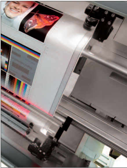
Überwacht durch Videokameras, druckt der DJet mit hoher Registerpräzision.
