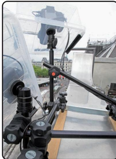
Langzeitüberwachung und Dokumentation einer Baustelle: Kameras mit Plastikschachtel gegen Witterung geschützt und je auf einem SUPERBALL® M-1 montiert und an einem COMBIROHR®-Gestell von FOBA am Dachrand befestigt.
