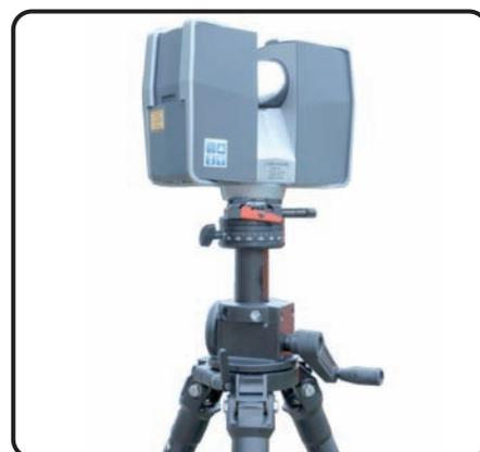
Laserscanner mit Hilfe des Panoramaaufsatzes ASTIU, der Schnellwechseinheit BALSO und der Schnellwechselplatte BALPU auf einem robusten Dreibeinstativ\* von FOBA montiert.
